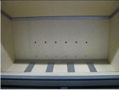
Retirer les canaux en inox et la vermiculite de sol.
