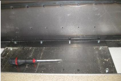
Retirer le cache en inox qui masque les vis de la tôle d'accès au ventilateur puis démonter cette dernière.
