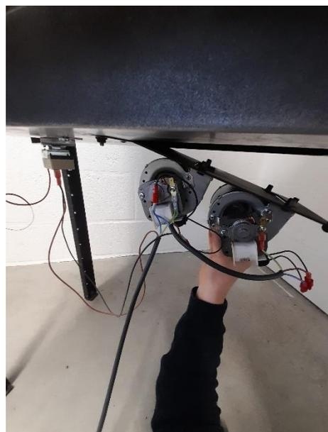
Placer la plaque support à l'horizontal et placer la de telle manière à ce que les « silent-blocs » du montage se logent dans les orifices prévus à cet effet.
