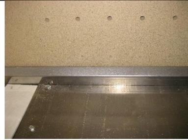
Retirer la réglette en inox qui maintient le bas des vermiculites de dos puis retirer celles-ci en commençant par celle du milieu.
