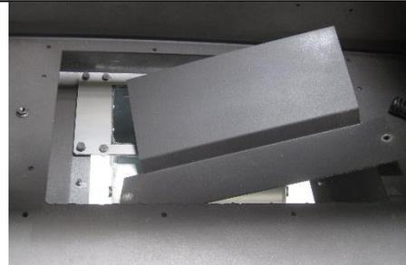
Retirer la plaque déflecteur devant la sortie du ventilateur (2 écrous M6) et retirer celle-ci, ou aller fixer en dessous de foyer.
