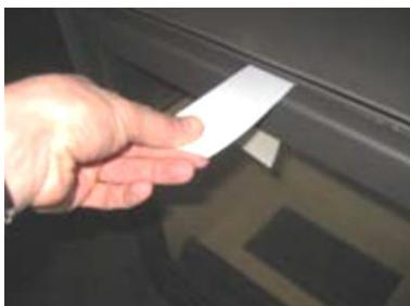
Si la bandelette ne reste pas coincée, il faut remplacer le joint ou effectuer un réglage sur l'excentrique de porte. Ce réglage rapprochera la porte du corps de chauffe. Pour ce faire, desserrez l'écrou à l'aide d'une clé de huit, faites pivoter l'excentrique vers l'arrière de l'appareil et resserrez l'écrou. Attention, si vous changez le joint après cette manœuvre, veillez à régler à nouveau l'excentrique vers l'avant de l'appareil. Votre revendeur est apte à réaliser ces interventions.
