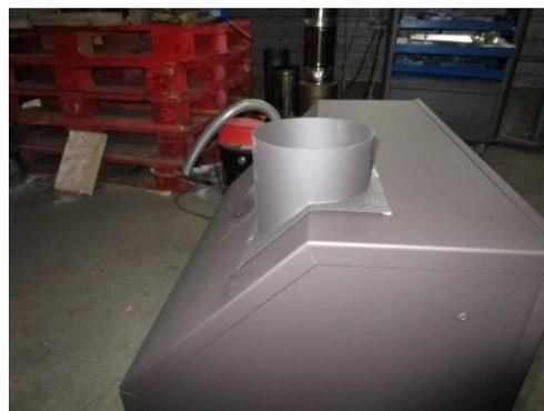
**Les appareils sans ventilation** doivent **impérativement** être équipés de 2 bouches d'air chaud avec une grille de finition (non comprise). Ces 2 sorties d'air chaud doivent être canalisées avec au moins 1 mètre de flexible alu diam. 125.
